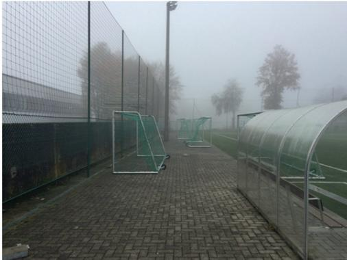
Une zone de propreté de 1 m. de largeur minimum (accès PMR, revêtement continu) doit donc être prévue en évitant la dolomie, le gravier, les revêtements à joints... La zone est réalisée en matériaux liés afin d'éviter la pollution des sols.
