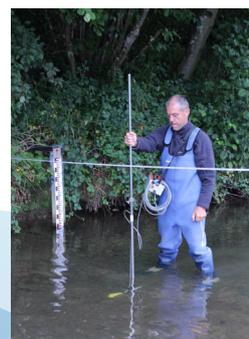
5. Courantomètre électromagnétique monté sur perche
