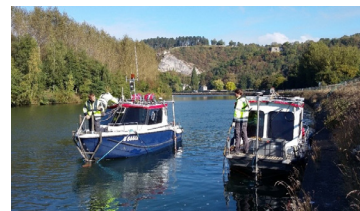
1. Bateaux avec sonar multifaisceaux
