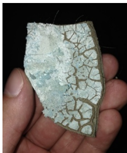
Figure 4.4 : Résidu séché des précipitations de l'eau de lavage des filtres de la piscine du Blocry
