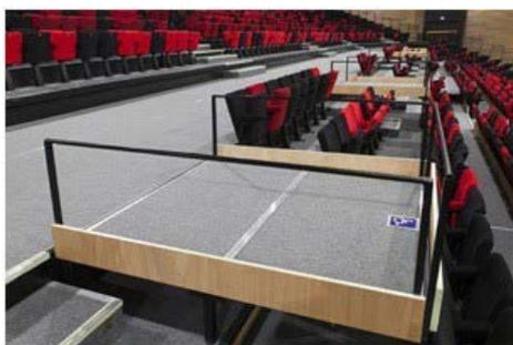
Les places réservées aux PMR se situent idéalement en haut et en bas des gradins, répartis parmi les autres places. Pour augmenter le confort, on prévoit également quelques sièges plus larges avec dossier et accoudoirs. Les assises ont les caractéristiques suivantes :
