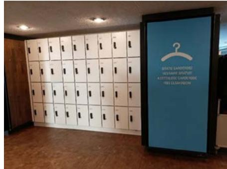
Prévoir une zone de dégagement adéquate autour du casier (aire de rotation de 150cm). Le casier doit être situé à une hauteur accessible aux personnes en chaise roulante, soit à une hauteur maximale de 80 à 90 cm du sol. La superposition de 2 à 4 rangées de casiers permet de rencontrer ce critère (Hauteur d'atteinte en chaise roulante = entre 40 et 140 cm du sol – idéalement entre 80 et 110cm).
