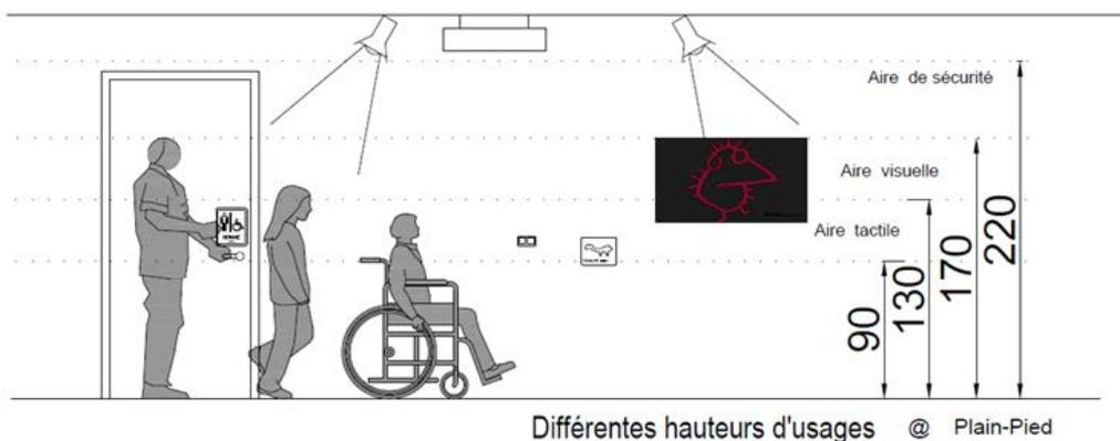
La signalisation permettant l'identification (numéro du local, d'un étage, heures d'ouverture) sera quant à elle placée entre **120 cm et 150 cm** de hauteur.
