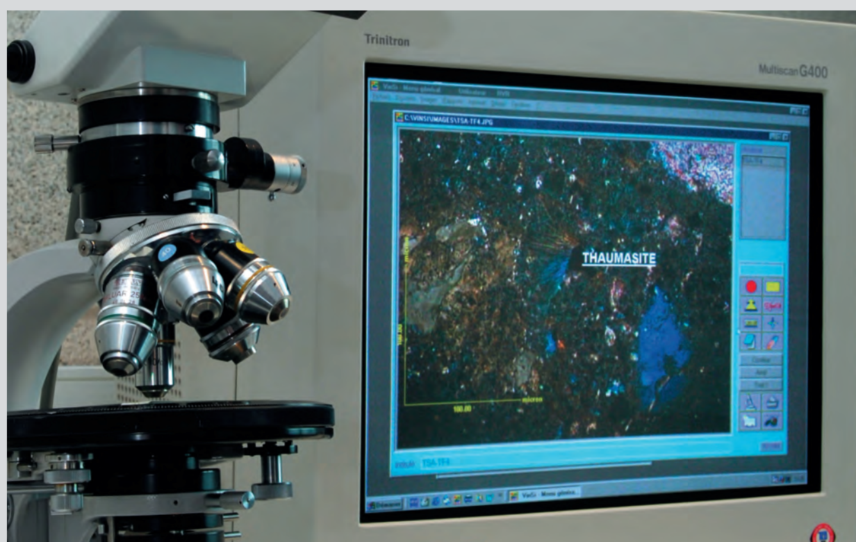
← Microscope et imagerie en lumière polarisée et en fluorescence. © SPW-Direction de l'Édition
