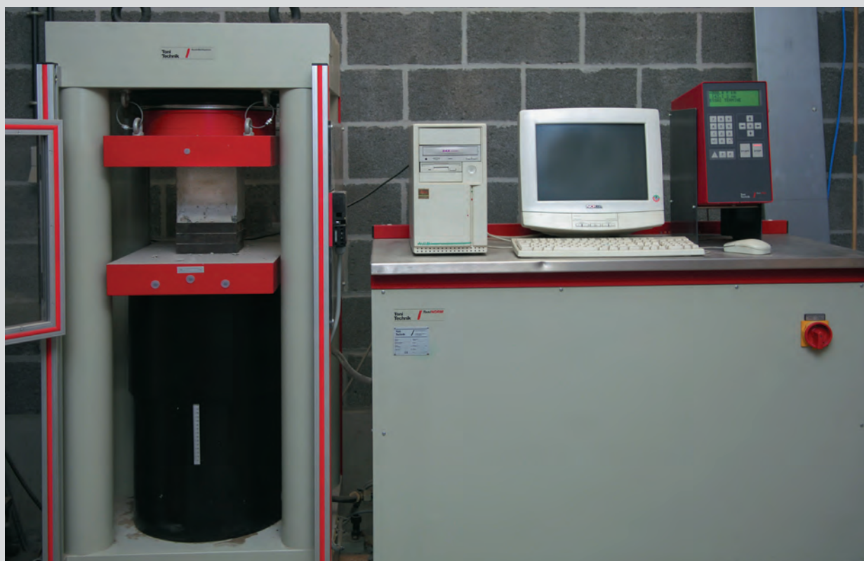
Presse d'écrasement hydraulique de classe 1 (EN 12390-4 (2000)) d'une capacité de 3 000 KN. © SPW-Direction de l'Édition
