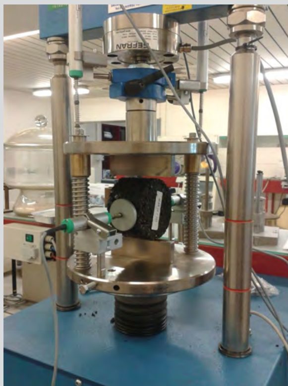
← Presse permettant de déterminer la résistance à la traction indirecte © SPW-Direction de l'Édition
