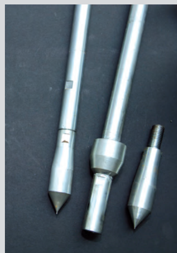
Pointe de type "CRR" - Angle de pointe 60° ; section 5 cm² © SPW-Direction de l'Édition
