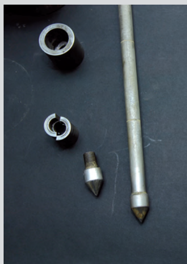
Pointe de type "Van Vuuren" - Angle de pointe 60° ; section 3,14 cm² © SPW-Direction de l'Édition
