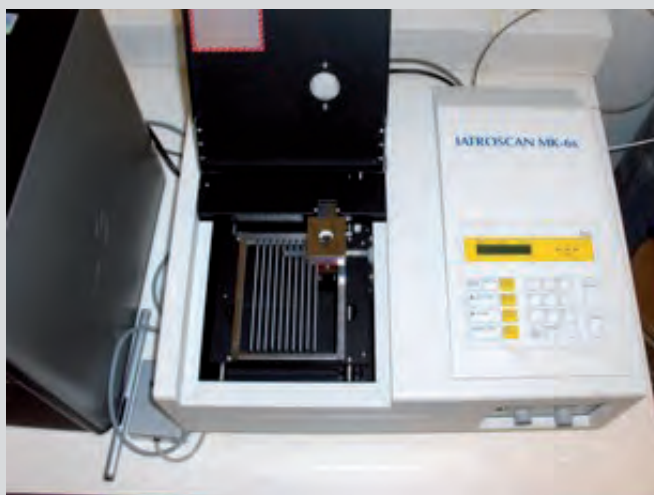
← Lecture par FID (Déflecteur par ionisation de flamme) des tiges de silice. © SPW-Direction de l'Édition
