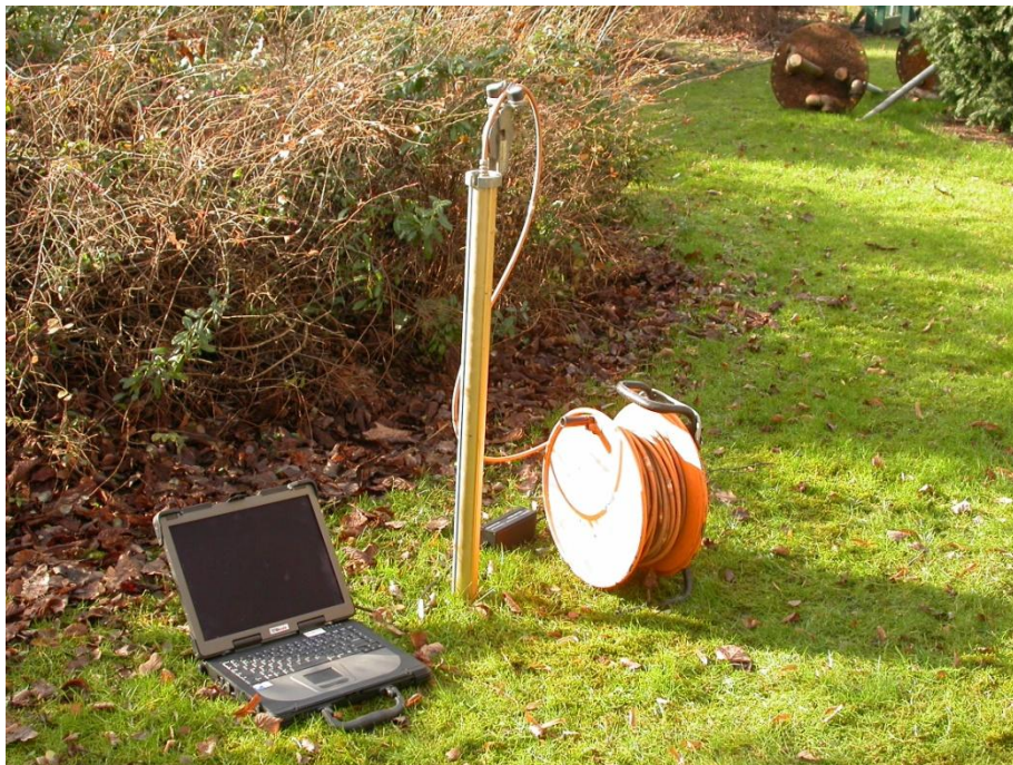
Mesures des déformations horizontales du sol à l'aide d'un inclinomètre.
