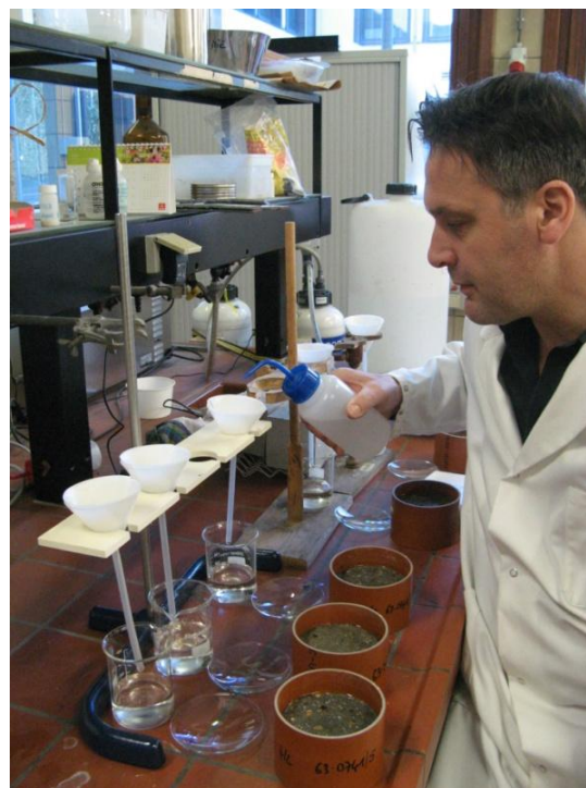
Résistance des bétons aux sels de déverglaçage – récolte des résidus d'écaillage
