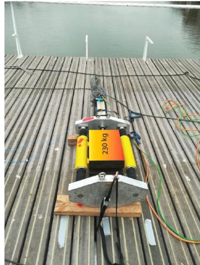
Afin de mesurer les différentes fréquences propres des modes, la passerelle a été excitée à l'aide d'un shaker positionné aux ventres des modes. Ce shaker consiste en une masse mobile oscillant selon des gammes de fréquences choisies.
