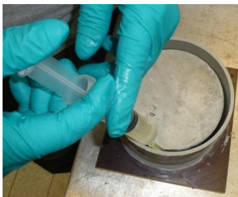
fig. 1: éprouvette avec rebord en PVC
