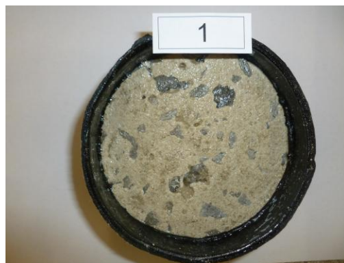
fig. 2: éprouvette avec rebord en feuille bitumineuse
