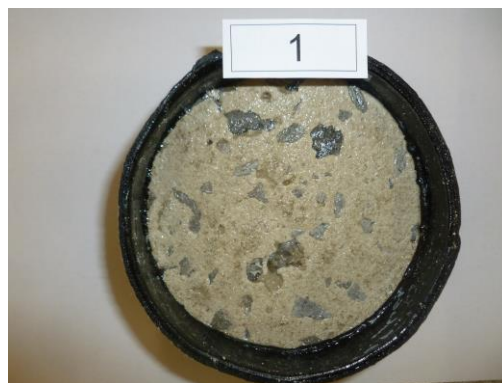
fig. 2: éprouvette avec rebord en feuille bitumineuse
