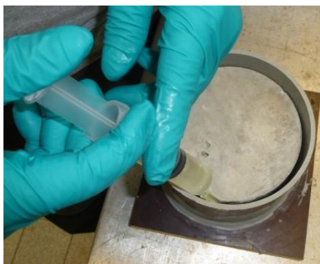
fig. 1: éprouvette avec rebord en PVC
