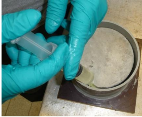
fig. 1: éprouvette avec rebord en PVC
