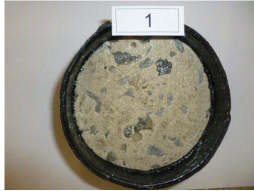
fig. 2: éprouvette avec rebord en feuille bitumineuse
