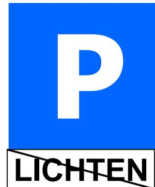
**F.5** Cartouches placés en dessous du signal principal indiquant la catégorie à laquelle s'applique le signal:
