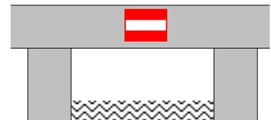
Passage recommandé (pont sur barrage), trafic en sens inverse possible (le panneau est jaune: D.1)
