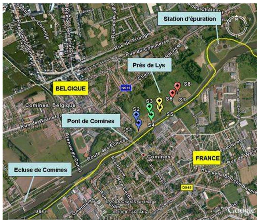
Figure 14 : Localisation des points de forage pour la caractérisation des terres à excaver pour le creusement du nouveau lit de la Lys au niveau des « Près de Lys » selon le projet initial du SPW-DGO2
