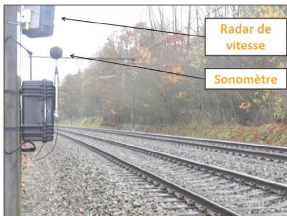
Figure 3 Exemple de dispositif mis en place lors des mesures
