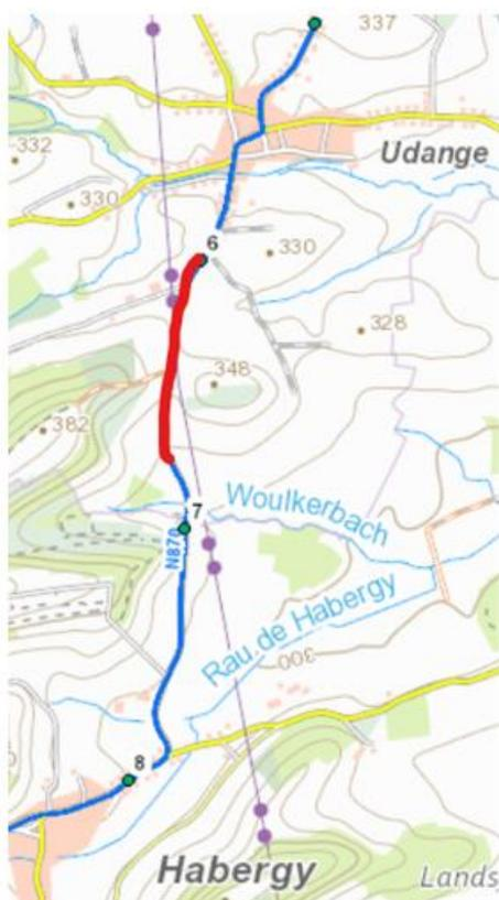
Concrètement, les travaux vont consister à renouveler les couches supérieures du revêtement sur la rue de Habergy, entre les bornes kilométriques 6,0 et 6,8.
