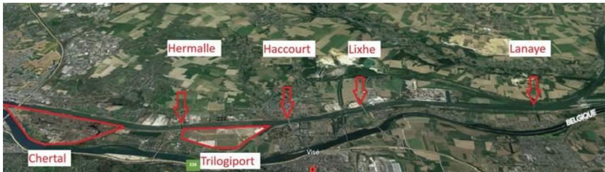
Concrètement, les ponts de Hermalle-sous-Argenteau, Lixhe et Haccourt vont être relevés respectivement d'environ 1,75 m, 1,60 m et 1,75 m. Le pont de Lanaye, situé plus en aval, est quant à lui déjà au bon gabarit et fera l'objet d'une signalisation fluviale spécifique.
