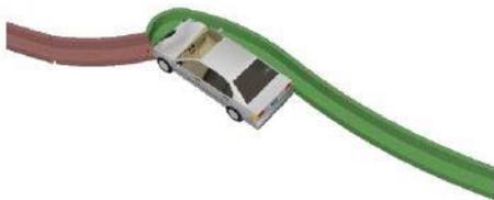
Le tableau ci-dessous illustre les différentes situations en termes de transitions où deux barrières de sécurité sont reliées l'une à l'autre, en tenant compte de la différence possible du niveau de retenue et de la largeur de fonctionnement des deux barrières de sécurité. Le même principe s'applique aux barrières de sécurité reliées à d'autres types de dispositifs de retenue.
